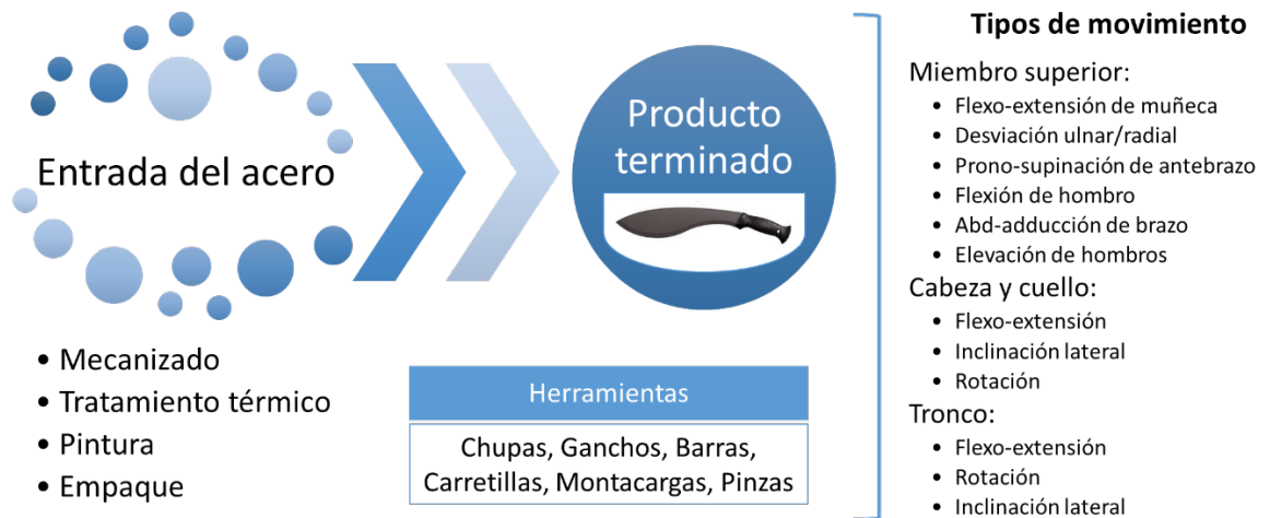
Figura 2. Proceso para elaboración del machete. Fuente: Elaboración propia
